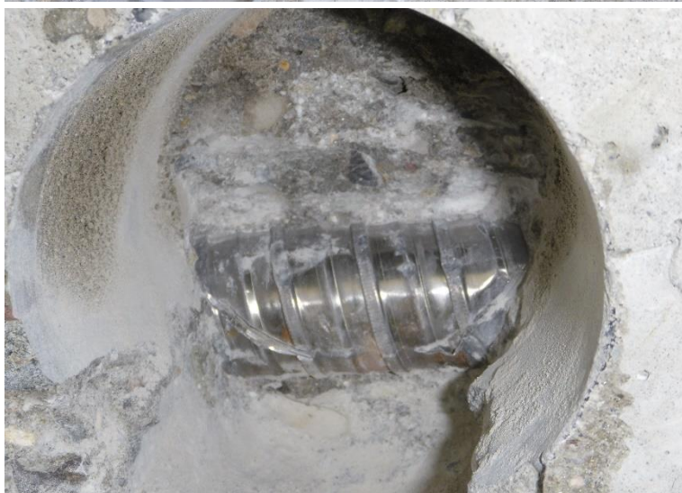
Obr. 3.28: Sonda P2 , kabel v ocelové chráničce; mírná povrchová koroze; krytí po chráničku 100 mm
