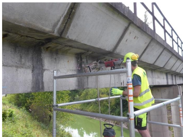
Obr. 3.12: Odběr jádrového vývrtu z pravého nosníku v 1. poli
