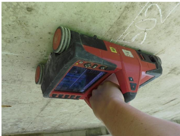
Obr. 3.33: Vyhledání předpínací a betonářské výztuže pomocí radaru HILTI PS 1000 X-Scan
