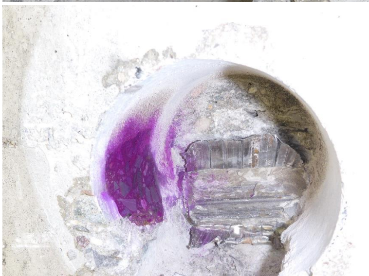
Obr. 3.29: Sonda P2 , kanálek plně zainjektovaný, injektáž suchá, dráty bez koroze; předpínací kabel je ve "zdravém" nezkarbonatovaném betonu
